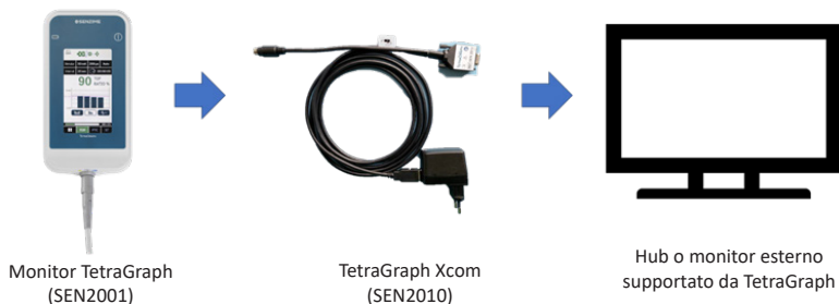
Figura 2 Diagramma a blocchi di collegamento
