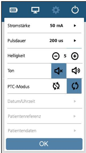
Zum Starten des manuellen Modus drücken Sie auf dem Startbildschirm die Schaltfläche Manuell. Wählen Sie in den Einstellungen den gewünschten Strom und die Impulsbreite. Die Standardeinstellung für den manuellen Modus ist 50 mA und 200  $\mu$ s. Drücken Sie die Schaltfläche TOF oder ST, um die Überwachung zu starten. Der MAN-Modus wird in der oberen rechten Ecke orangefarben angezeigt.
