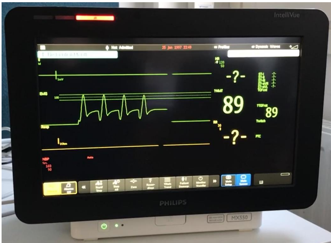
Abbildung 8. Bildschirmansicht des Philips IntelliVue Monitors, der die TOF-Ergebnisse mit einer EMG-Kurve anzeigt, wenn der TOFrat-Wert 89 % beträgt.
