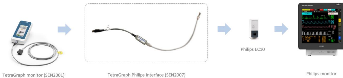
Abbildung 2. Zeigt die Produkte, die für den Anschluss des TetraGraph Monitors an Philips IntelliVue erforderlich sind.
