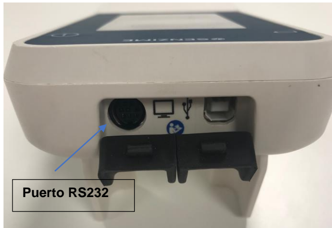
Figura 3. El puerto RS232 del monitor TetraGraph permite conectar dispositivos externos.
