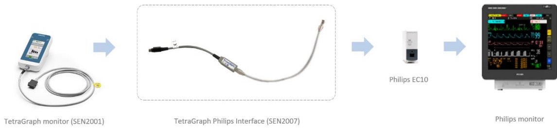
Figura 2. Ilustración de los productos necesarios para conectar el monitor TetraGraph a Philips IntelliVue.
