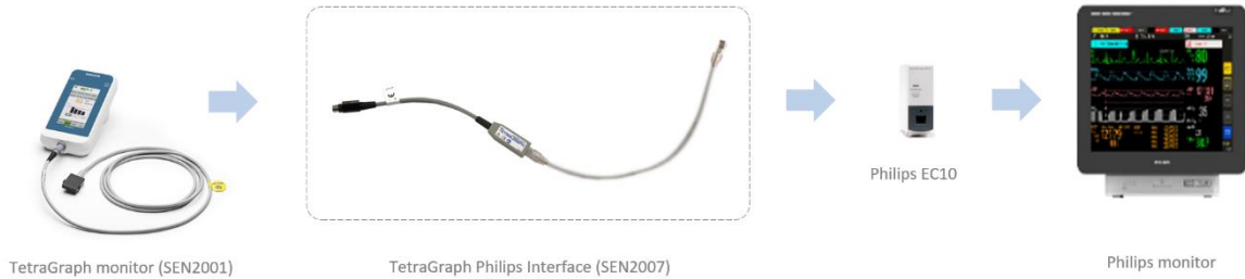
Kuva 2. TetraGraph-näytön yhdistämiseen Philips IntelliVue -näyttöön tarvittavien tuotteiden kuvaus.
