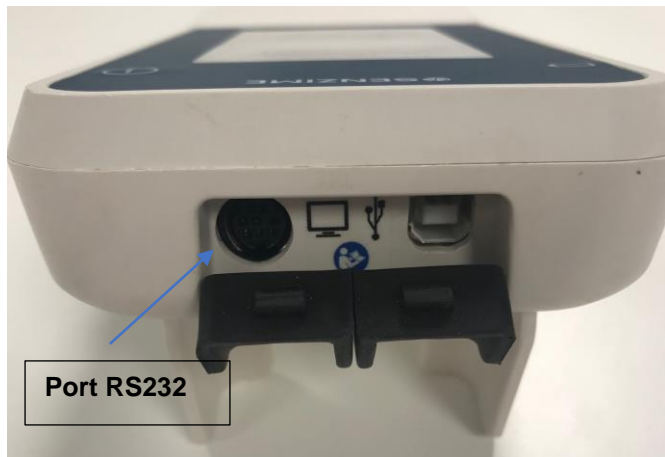
Figure 3. Le port RS232 du moniteur TetraGraph permet de connecter des dispositifs externes.
