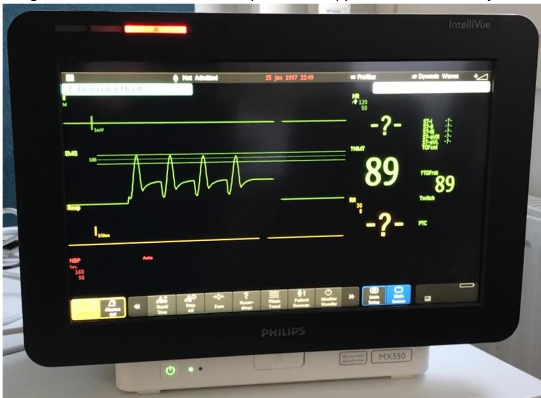
Figure 8. Capture d'écran du moniteur Philips IntelliVue affichant les résultats du TOF avec une onde EMG lorsque le TOFrat numérique est de 89 %.
