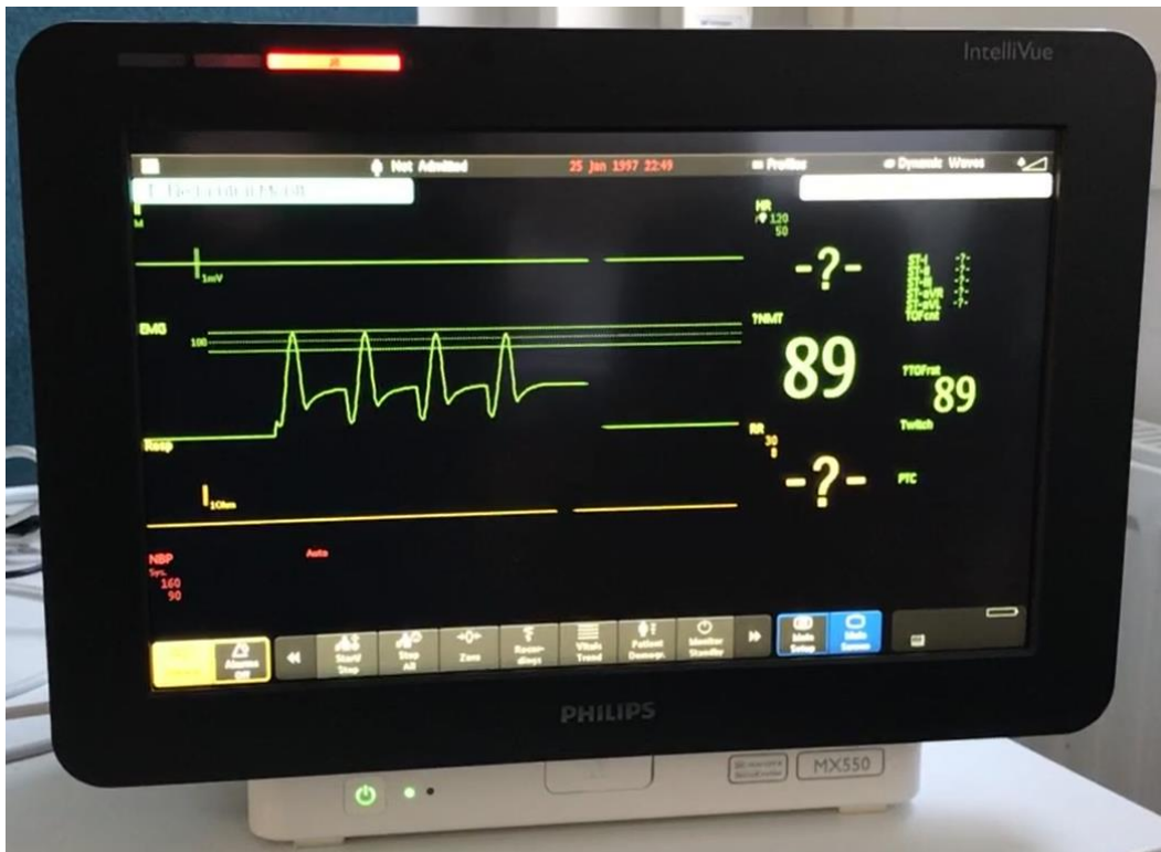
Figura 8. Schermata dello schermo Philips IntelliVue in cui sono mostrati i risultati TOF con un'onda EMG quando il valore di TOFrat è 89%.
