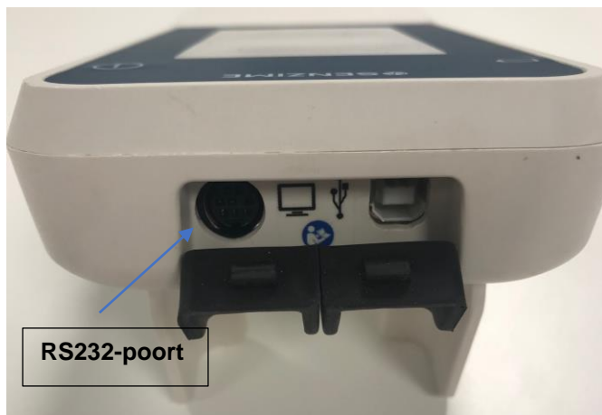
Figuur 3. De RS232-poort van de TetraGraph-monitor maakt het mogelijk om externe apparaten aan te sluiten.
